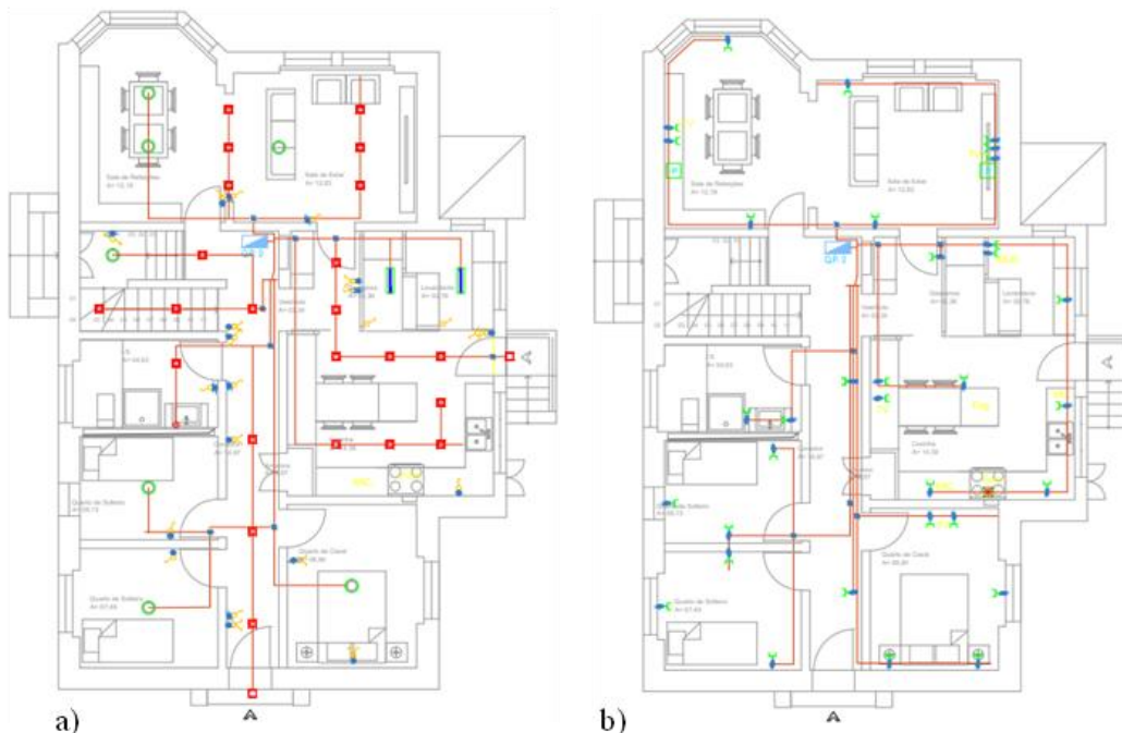
Figura 6. 12 - Planta do piso 0, rede elétrica, a) pontos de iluminação; b) pontos de tomadas elétricas e telecomunicações (Fonte: de autor).
