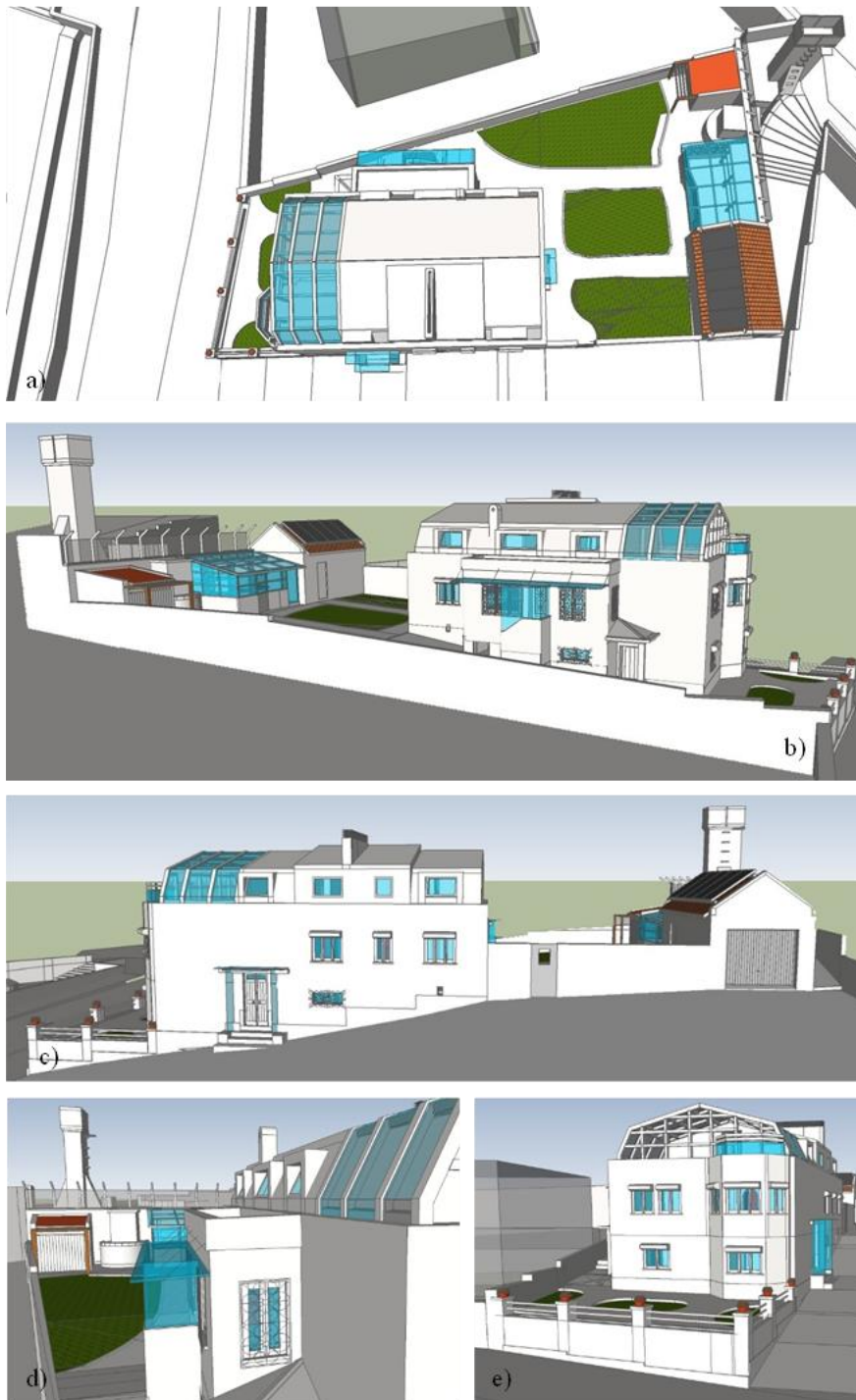
Figura 6A. 9 - Perspetiva geral da proposta alternativa: a) vista aérea do conjunto; b) alçado poente (Rua 5 de Outubro); c) Vista nascente da Travessa de acesso para a moradia o logradouro e a garagem; d) pormenor da entrada da cozinha protegido com a pala e resguardo em vidro e, o remate da cobertura com capeamento metálico, de chapa dobrada de aço galvanizado, e o pormenor da cobertura do terraço jardim; e) fachada sul (Rua Elias Garcia), pormenor da zona da entrada principal com o alpendre em vidro e o terraço jardim na cobertura, (Fonte: de autor).
