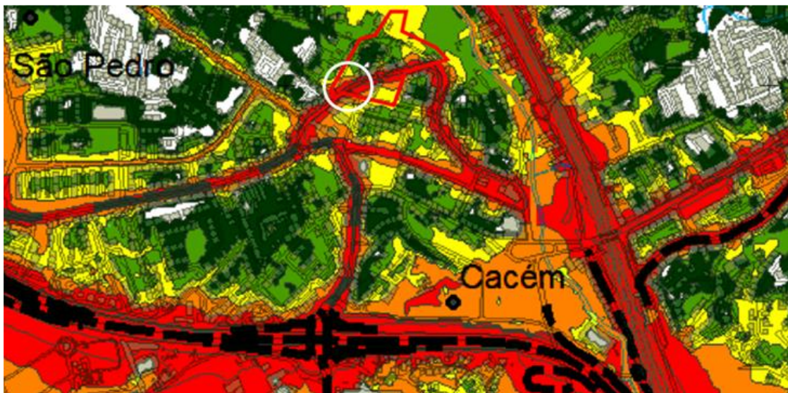
Figura 6A. 13 - Extrato do Mapa de Ruído do concelho de Sintra: localização da moradia em estudo na Planta do Mapa de Ruído referente ao indicador noturno, L_n , do concelho de Sintra. As cores laranja e vermelho representam L_{den} > 55 dB (A) e L_{den} > 60 dB (A), respetivamente. No referido mapa as restantes cores da legenda (verde escuro, verde e amarelo) correspondem L_n \leq 50 dB (A) [1].
